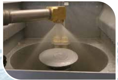
feinperlige Verdüsung zur Sauerstoffanreicherung
